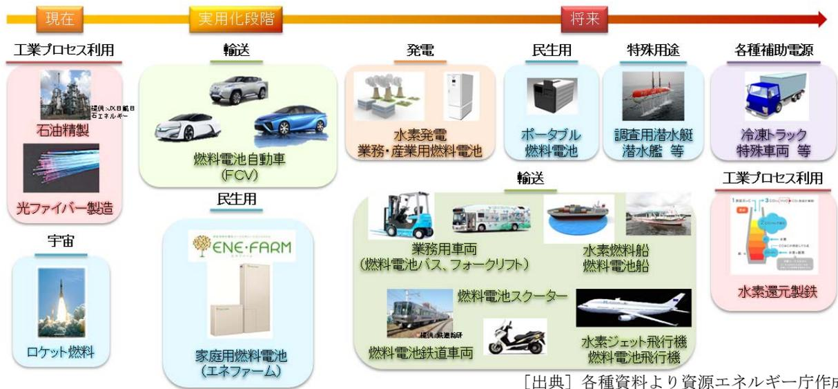
省エネルギーについて言えば、燃料電池は、燃料である水素と、空気中の酸素の電気化学反応から電気エネルギーを直接取り出すため発電効率が高い。また、電気と熱の両方を有効利用することで、更に総合エネルギー効率を高めることが可能である。このため、燃料電池の活用を広げることで、大幅な省エネルギーにつながり得ると考えられる。
